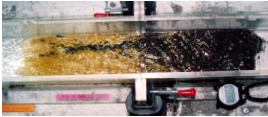
図3 幅10cmの水路で、植生の有る無しによる土砂の運ばれ方の違いを観察。ビニル紐で草を植えると、水流で倒れて布団を敷いたよう。その上を一番大きい石を先頭に列を作って土砂がコロコロと運ばれる。砂礫だけでは粒同士がかみ合って動きが遅い。
