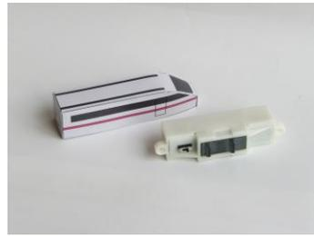
地面に面した部分を超音波で振動させ、タイヤがなくても走ります。
