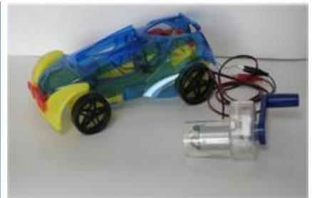
手回し発電機などでスーパーコンデンサーに蓄電させて走らせます。
