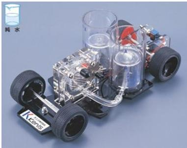
固体高分子型水電解・燃料電池セルで水の電気分解と発電を行うことができます。約1.8V起電します。
